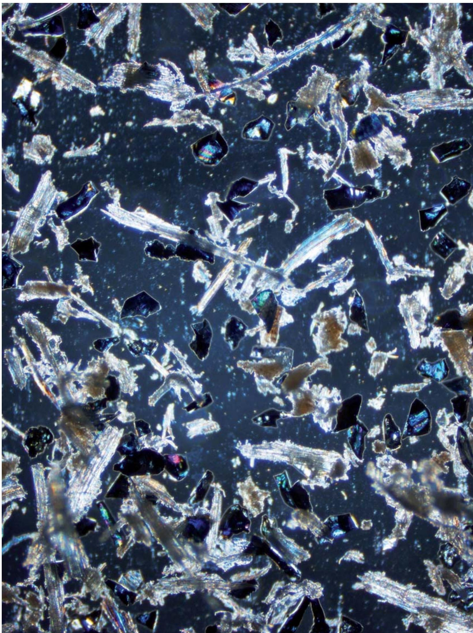
Piliny a brusivo, polarizované světlo, temné pole | Saw dust and abrasive material, polarised light, dark field
