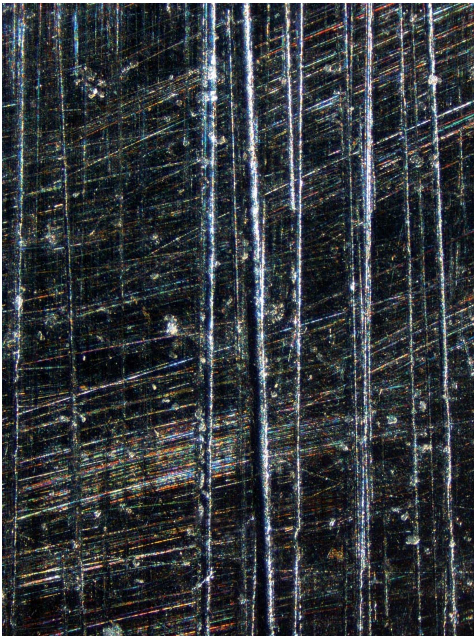
Povrch kovového dřevoobráběcího nástroje | Metallic woodworking tool surface
