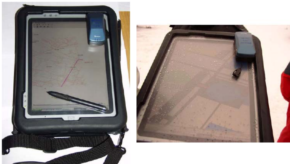
Obr. V.5.3 Přenosný počítač HP compaq TC1100 uzavřený ve speciálním pouzdře pro práci v terénu. Vlevo snímek pořízený v „laboratorních“ podmínkách, vpravo snímek z terénu. Modrá krabička v pravém horním rohu obou snímků je přijímač GPS, komunikující s počítačem prostřednictvím rozhraní bluetooth. Na levém snímku je vidět i speciální pero používané k ovládání počítače.
