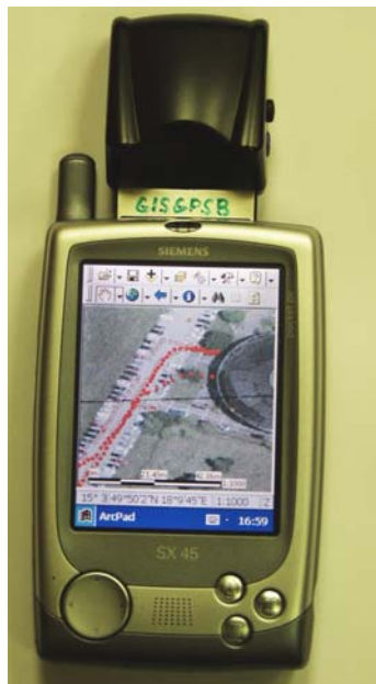
Obr. II.1.5 Ukázka mobilního telefonu (přesněji počítače třídy palmtop se zabudovaným modulem pro přenos dat prostřednictvím GSM), připojeným přijímačem GPS a spuštěným programem pro mobilní GIS.
