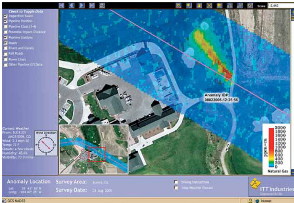
Obr. V.8.11 Ukázka využití diferenčního absorpčního lidarů pro detekci úniků metanu z potrubí [251].
