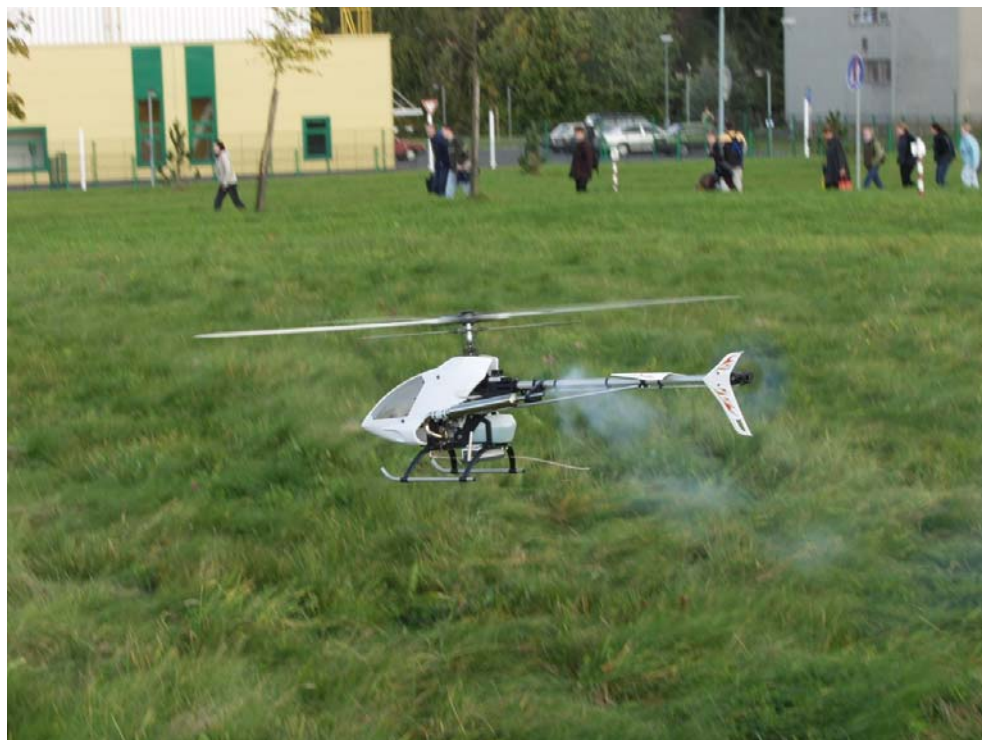
Obr. II.2.16 Model vrtulníku osazený digitální kamerou s on-line přenosem obrazu na zem.
