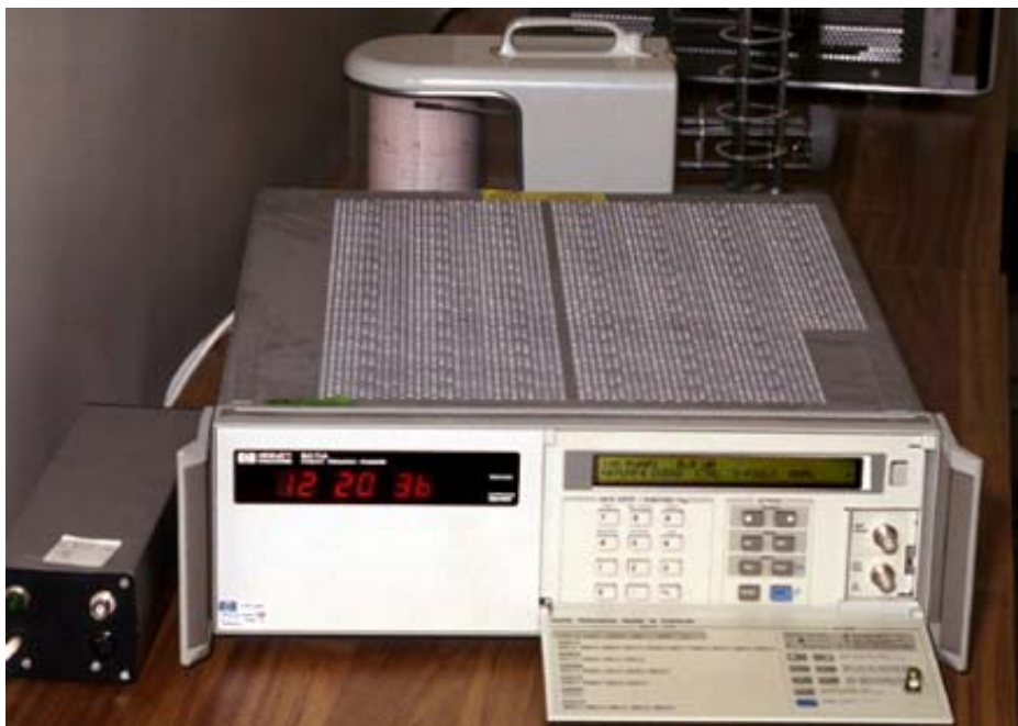
Obr. II.9.2 Ukázka praktické (fyzikální) realizace cesiových atomových hodin (HP 5071A [17]).
