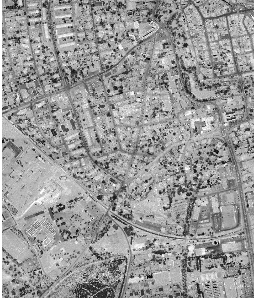
Obr. V.8.2 Rastrový obraz vytvořený z intenzit odražených signálů. Znárodněna je část města Memmingen v Německu. Prostorové rozlišení rastru je 0,5 m na pixel [117].
