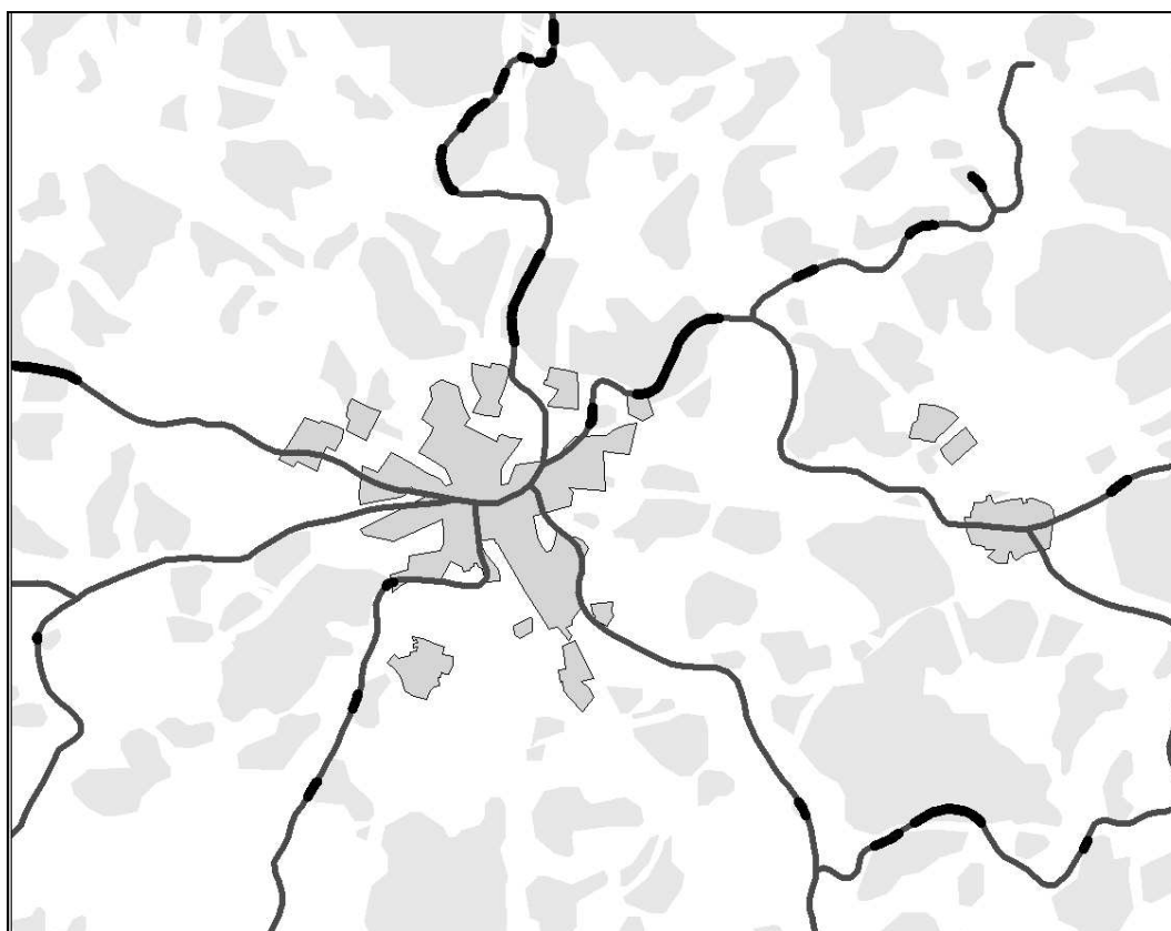
obr. 3.34 – nalezení všech úseků procházejících lesem pomocí topologického překrytí
