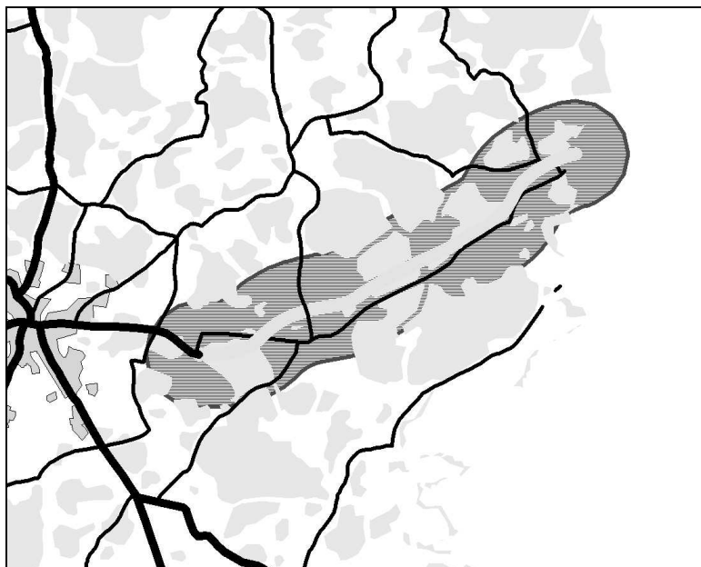
obr. 3.32 – obálka (buffer) ve vzdálenosti 3 km od dálnice
